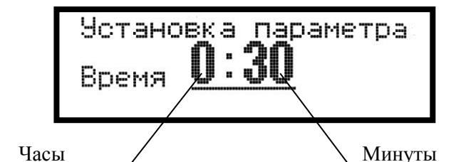
Рисунок 6 – Вид дисплея в состоянии задания времени нагрева
