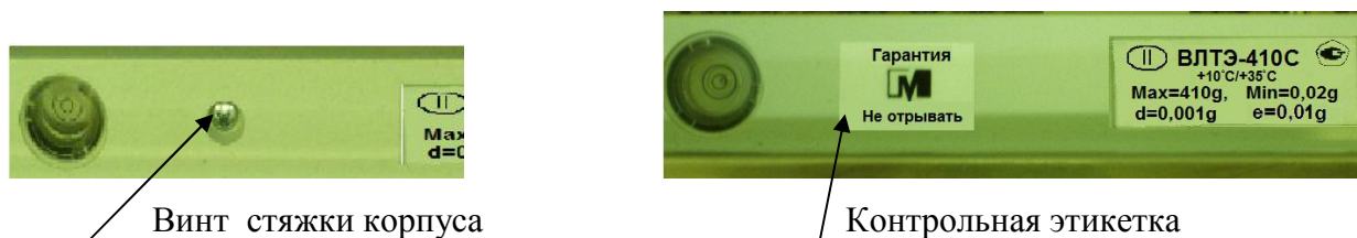
Рисунок 2 - Схема пломбирования от несанкционированного доступа
