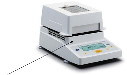
Место нанесения поверительного клейма (знака поверки в виде наклейки).
