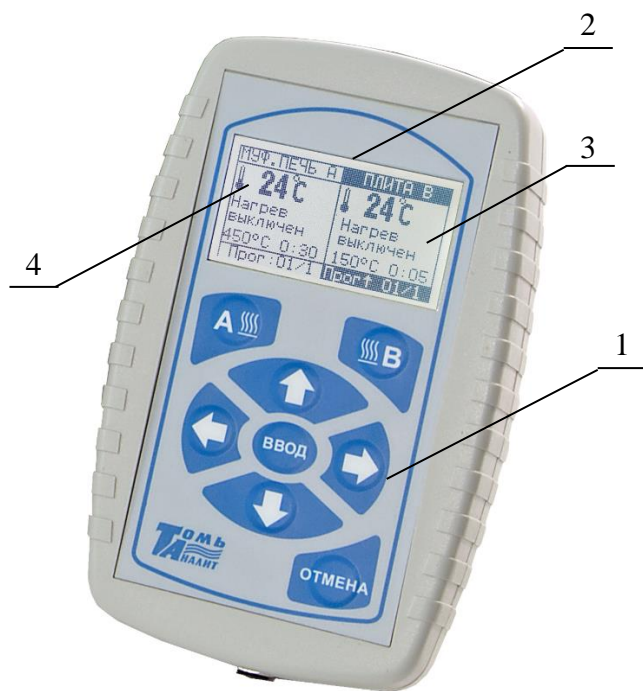
1 – панель с управляющими кнопками; 2 - дисплей; 3 – окно камеры выпаривания; 4 - окно камеры озоления
