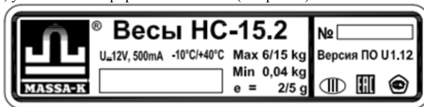
Рисунок 9 – Планка фирменная весов
