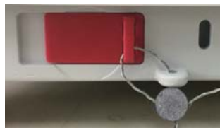
Заблокировано с использованием проволочной пломбы
