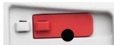
Блокировка включена и опломбирована бумажной пломбой
