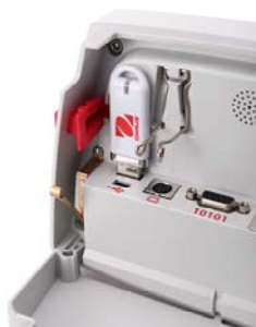
Интерфейсные разъемы на задней панели терминала
