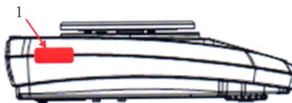
Рисунок 2 – Схема пломбировки от несанкционированного доступа, обозначение места нанесения знака поверки (1 – пломба в виде разрушаемой наклейки, может быть использован знак поверки в виде разрушаемой наклейки)
